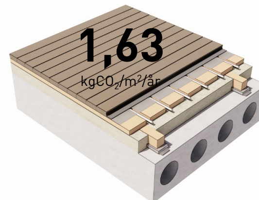
Forskalling, mineraluld og aluminium varmefordelingsplader
