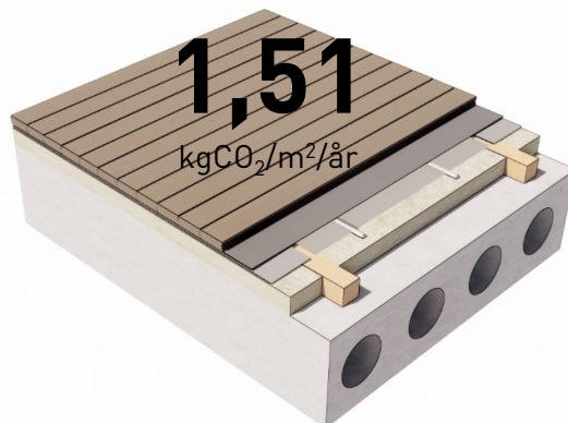
Selvbærende stål varmefordelingsplader og mineraluld
